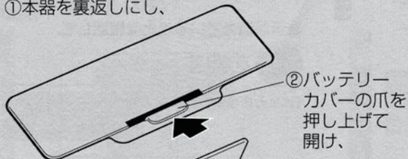
②バッテリーカバーの爪を押し上げて開け、
