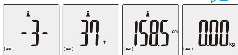
0.00kgが表示されたら、正しい姿勢で本体に乗ってください。ピッピッと鳴ったら測定終了です。測定結果が順番に表示され、最後に時刻を表示し、自動的に電源が切れます。
