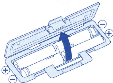
●乾電池が消耗してくると表示部に
