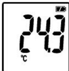
**[MODE]** を押して温度表示モードに切り替えます。
