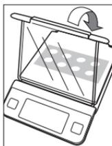
透明カバーの下側を計量皿と合わせ、そとがぶせる。
