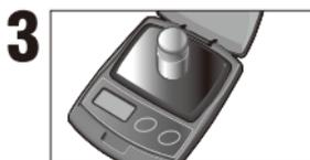
100が点滅している状態で、計量皿の中央に付属の校正用分銅100gを静かに載せる
