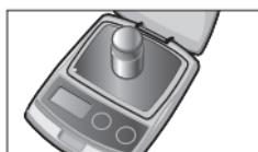
100が点滅している状態で、計量皿の中央に校正用分銅100gを静かに載せる。
