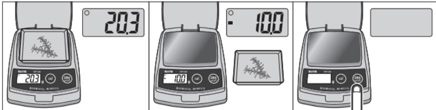
4. 計量物を載せると、計量物の重さだけが表示される。
