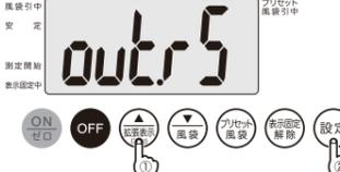
現在の設定 (初期設定はRS-232C) が表示され、押すごとに、out.Pr (プリンタ設定) → out.rS (RS設定) と表示は切り替わり、出力信号が設定できます。
