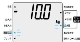
**メモリ1**または**メモリ2**を押してください。登録されている風袋量が表示され、使用したプリセット風袋のメモリ番号を示す▶が点灯、着衣量の入力指示を示す▶が点滅します(プリセット風袋量の設定方法については22ページ便利な機能『メモリ書き換えモード』をご参照ください)。
