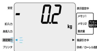
測定台に何も載っておらず風袋の設定がされていない状態で、表示が0.0kgになっていないことを確認します。
