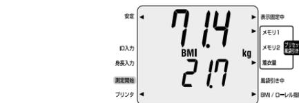
測定台の中央に載ると、測定値が表示されます。測定結果表示後、設定に従ってプリントされます。測定台から降りると、自動的にID入力画面(または測定開始画面)に戻ります。
