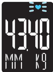
本機では脈拍測定をONにしている場合、体組成の後に脈拍を測定します。その際に運動や入浴の直後などで脈拍が速く、一般的な平常時の範囲をはずれている場合、測定結果の画面の中に♥マークを点滅してお知らせします。
