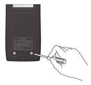
2. 電池の+側を上にして入れ、電池フタを閉め、2箇所のネジをしっかりと締める
