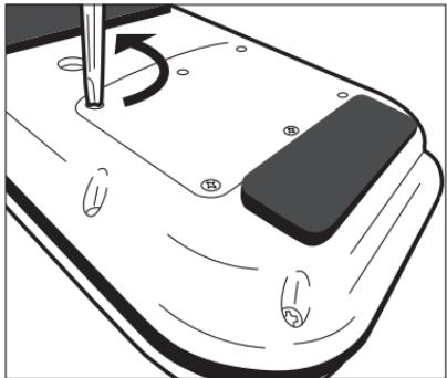
①付属のドライバーまたは市販のプラスドライバーで電池フタのネジ(6本)を左に回して外し、電池フタを取り外す
