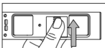
④電池カバーを矢印の方向へ閉める。
