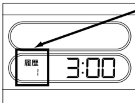
①履歴表示に「履歴1」が表示されているのを確認する。
