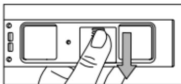
①本体裏の電池カバーを矢印の方向へ開ける。
