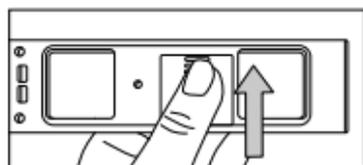
① 本体裏の電池カバーを矢印の方向へ開ける。
