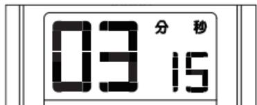
①表示部にセットした計測時間が表示されているのを確認する。
