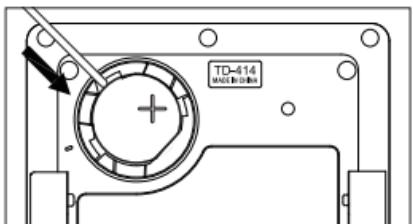
電池フタを開けて、図の部分につまようじなど電気を通さない細い棒で持ち上げて電池を取り出し、新しい電池を入れてください。
