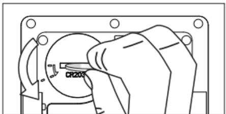
①電池フタの溝へコインをあわせ、矢印の方向に回す。
