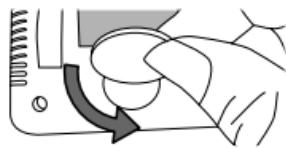
①本体裏の電池カバーの溝へコインをあわせ、矢印(OPEN)の方向に回す。
