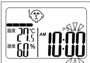
①「セット」スイッチを2秒以上押し続けてください。12が点滅し、時刻の設定モードになります。
