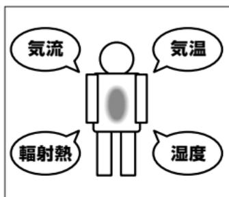
熱中症発症に関わる要因は、気温や湿度だけでなく、日射・地面からの照返しによる熱(輻射熱: ぶくしゃねつ)も関係しています。日射や地面からの照返しは、普通の温度計では測定できず、黒球を使った温度測定が必要とされています。本器は、黒球を搭載しているため、地面の状態や身長の違いによる局所的な暑熱環境を正確に測定できます。
