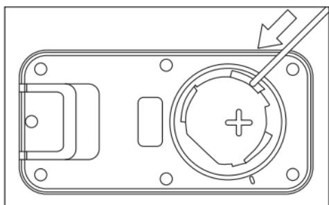
図の部分に、つまようじなど電気を通さない細い棒を入れて持ち上げ電池を取り出し、新しい電池と交換してください。
