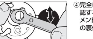
④完全にフックに入っているかを確かめるためにつり下げ用アタッチメントを左右に動かしてから黒球の裏側に来る位置に合わせる。
