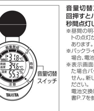
音量切替スイッチ(⊕)を1回押すとバックライトが約5秒間点灯します。
