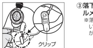
③落下防止ストラップのクリップでヘルメットの耳ひもに止める。
