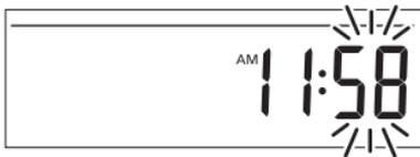
④ 「分」が点滅するので、**▲** を押して「分」を合わせ、**SET** を押して決定する
