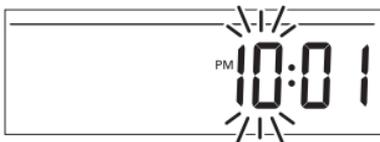
③ 「時」が点滅するので、**▲** を押して「時」を合わせ、**SET** を押して決定する
