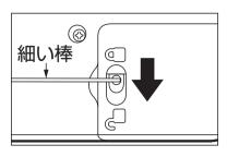
1.電池フタロックスイッチ のくぼみに細い棒を 入れてオープン方向に 移動させる。 (矢印の方向に)
