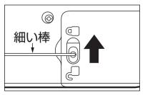
5.電池フタロックスイッチ のくぼみに細い棒を 入れてロック方向に 移動させる。 (矢印の方向に)
