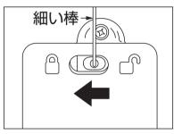
5.電池フタロックスイッチ のくぼみに細い棒を 入れてロック方向に 移動させる。 (矢印の方向に)
