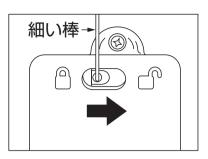
1.電池フタロックスイッチ のくぼみに細い棒を 入れてオープン方向に 移動させる。 (矢印の方向に)
