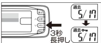
保護したい日付の過去メモリ画面でメモリボタンを3秒長押しするとカギマークが表示され、過去メモリが保護されます。
