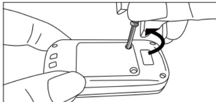
①本体裏面の電池カバーのネジ2箇所を、付属のドライバーまたは、市販の小型ドライバーを使ってゆるめる
