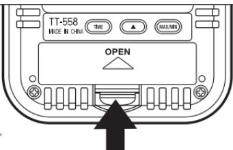
1. 本器裏面の電池フタを矢印の方向に開けてください。
