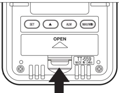
1.本器裏面の電池フタを矢印の方向に開けてください。
