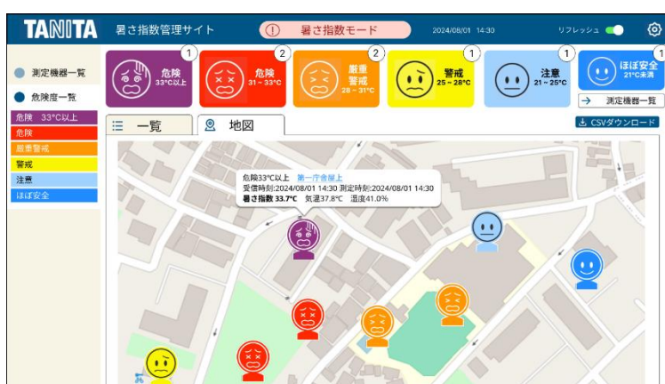
各地点の暑さ指数の注意レベルを地図上で確認できる管理画面（左）と モバイルデータ通信機能を持つ黒球式暑さ指数センサー「TC-350」
