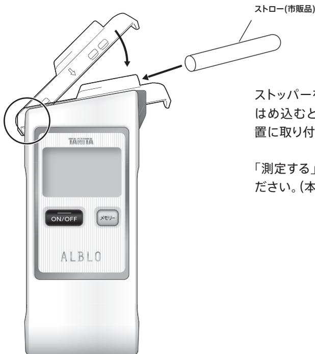
ストッパーを左図の位置にひっかけてからはめ込むと、「カチッ」と音がして所定の位置に取り付けられます。
