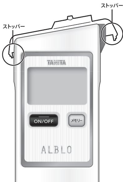
ストッパーを左図の位置にひっかけてからはめ込むと、「カチッ」と音がして所定の位置に取り付けられます。
