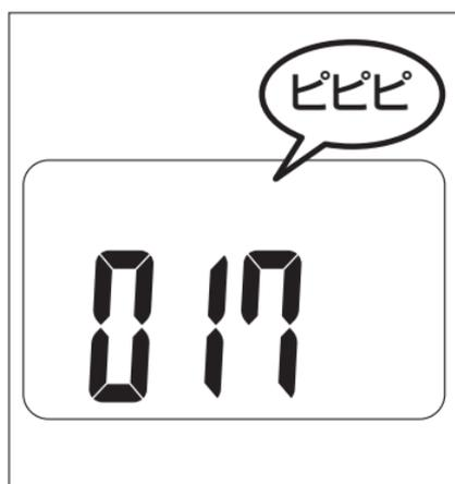
2.ピピピと音がしてセンサー使用回数が表示される。
