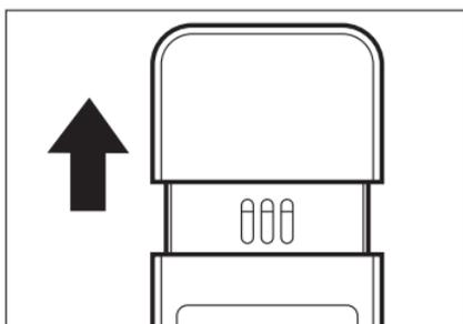
1. センサーキャップを引き上げて電源をONする。
