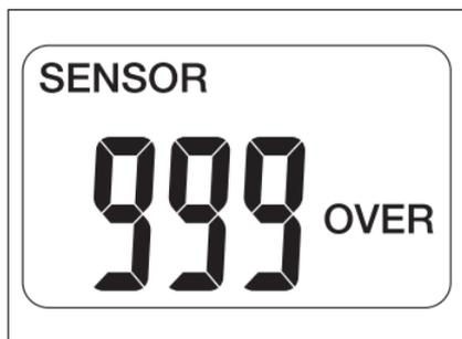
1. センサー使用回数が1000回以上になると「SENSOR」「OVER」が点灯表示します。
