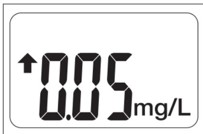
6.ピピピと音がして測定結果と換気お知らせサインが約4秒間表示される。
