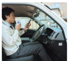
スマートフォンとつないで最大3カ所まで測定結果を送信可能。
