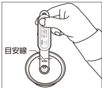
スープなどの測定物にセンサー部を完全に入れて、ONボタンを約5秒間押し続けてください。
