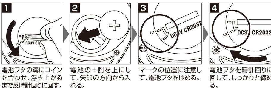
電池フタの溝にコインを合わせ、浮き上がるまで反時計回りに回す。
