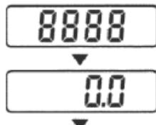
2). 計る物を入れる容器を計量皿にのせて、容器の重さが表示されましたら再度「ON・風袋」スイッチを押してください。表示は「**00**」となります。
