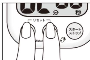
③ 「分設定」ボタンと「秒設定」ボタンを同時に1回押して表示を「00分00秒」にし、最初から時間をセットする
