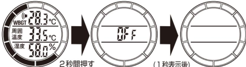
電源ONする場合は、ON/OFFスイッチを約2秒間押します。
