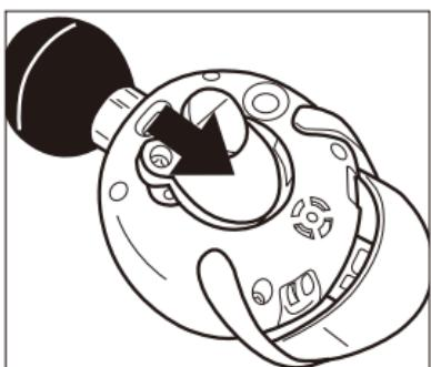
③電池フタのツメを本体の凹に合わせ電池フタを元の位置に取り付けネジを時計回りに締める
