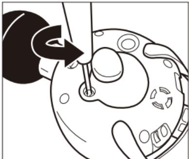
①付属のドライバーまたは市販の小型ドライバーを使って、電池フタのネジを時計回りと逆方向に回して外す
