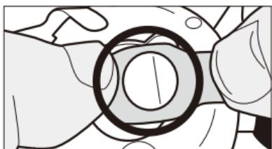
④完全にフックに入っているかを確認するためにつり下げ用アタッチメントを左右に動かしてから黒球の裏側に来る位置に合わせる。
