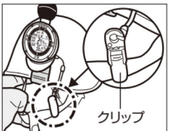
③落下防止ストラップのクリップでヘルメットの耳ひもに止める。
