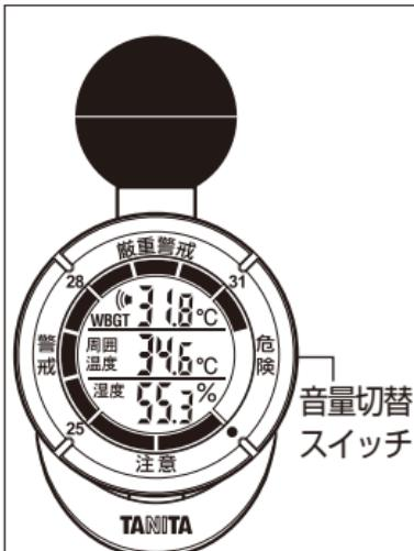
音量切替スイッチ(音量)を1回押すとバックライトが約5秒間点灯します。
