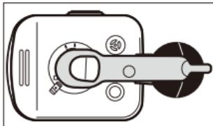
4. 完全にフックに入っているかを確認するためにつり下げ用アタッチメントを左右に動かしてから黒球の裏側に来る位置に合わせる。
