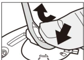
つり下げ用アタッチメントが付いている電池フタのフックを親指で抑え、つり下げ用アタッチメントを上側(矢印方向)に引っ張って外す。
